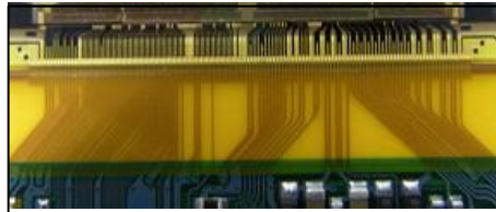
狭ピッチ細パターン配線基板のインターフェースFPCとの接合
